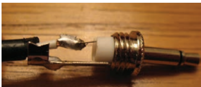
تصویر ۸۵- نقاط اتصال سیستم‌های نان سیمتریک
